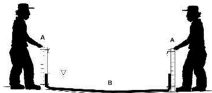
Figura 4. Obtención de un perfil microtopográfico con mangueras de nivel.
